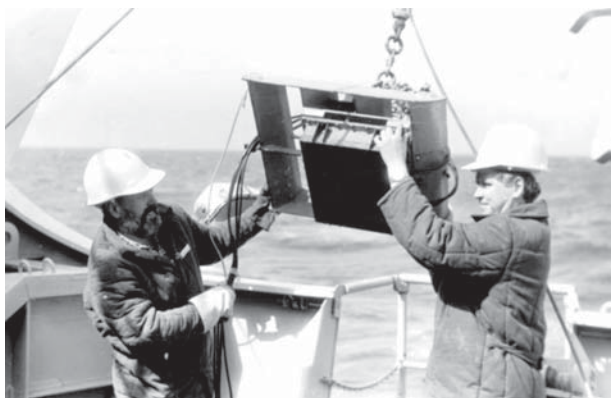
Спуск на кран-балке многоэлементной антенны накачки параметрического гидролокатора. НИС «Академик Иоффе», Атлантика, 1989 г.
