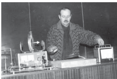
Заведующий демонстрационным кабинетом О.В. Осипенко проводит демонстрационный эксперимент «Электродинамическое подвешивание диска с током над проводящей поверхностью»
