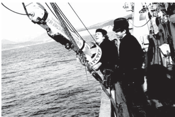
Испытания буксируемого блока антенн параметрических гидролокаторов в Черном море, 1985 г.
