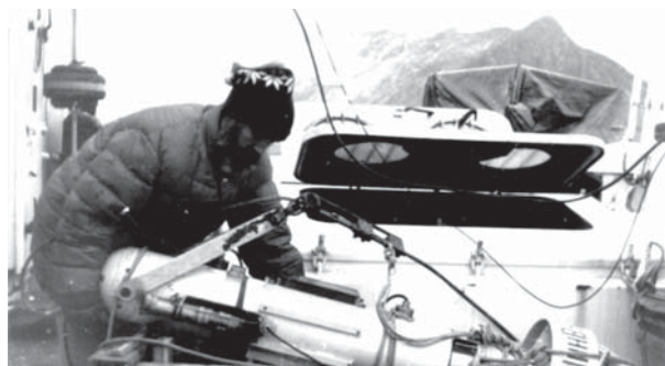
Буксируемые антенны ПГЛ. Испытания у Новой земли. НИС «Профессор Штокман», осень 1987 г.
