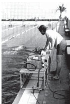
Испытание кафедральной аппаратуры для измерения по гидроакустическому каналу параметров пловцов олимпийской команды
