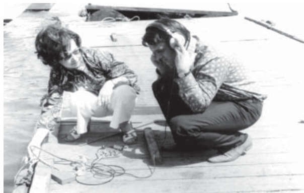
Испытания звукочувствительного электретного кабеля. Таганрогский залив. С.П. Белкина, С.А. Борисов
