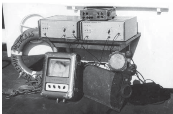
Параметрический гидролокатор ППЛ-5м на борту НИС «Академик Мстислав Келдыш», 1981 г.
