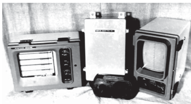
Первый в отечественной и мировой практике серийный рыбопоисковый эхолот с параметрическим режимом, созданный на кафедре совместно с НИИ «Бриз»
