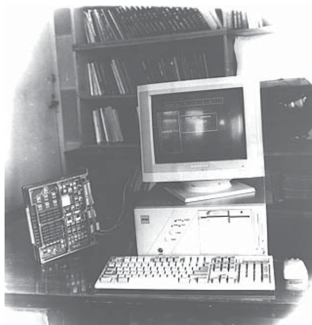
Векторный ускоритель к персональным компьютерам типа IBM PC AT
