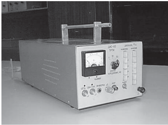
Доплеровский измеритель скорости движения объектов ДИС-83
